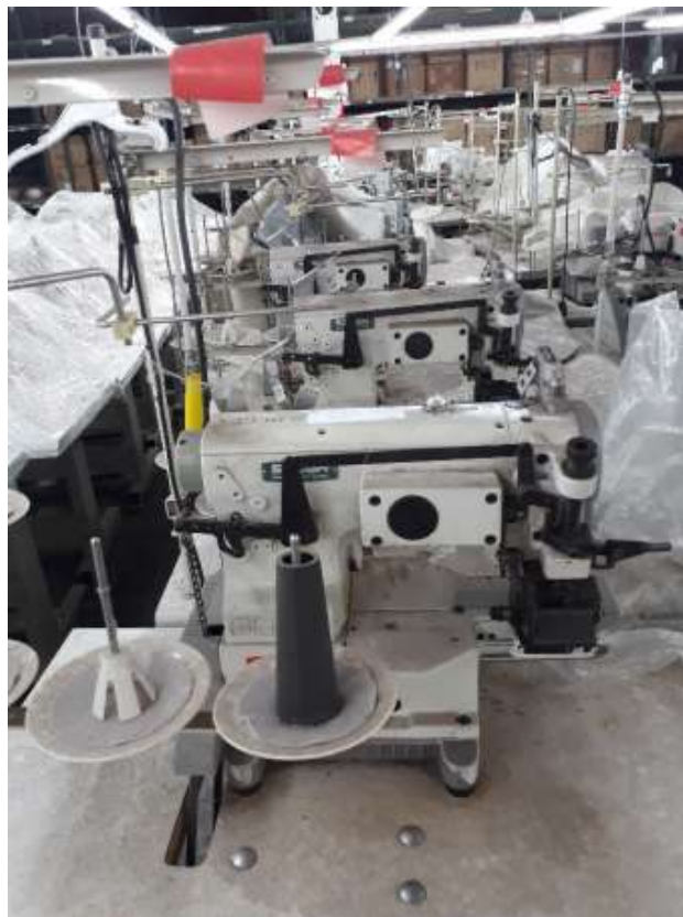
M – 70 – Galoneira Cilindrica - Siruba - C007J (2 unidades)
